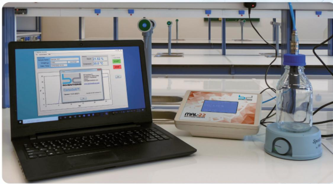
El dispositivo Mud Analysis Logging MAL-22 de BD Inventions es un instrumento de sobremesa preciso, rápido y económico que cumple con las normas EN ISO 10693:2013, ASTM D4373-02(2007), y normas ASTM D1756-02(2007) para el cálculo de la relación calcita/dolomita en muestras de suelo y sedimentos.
